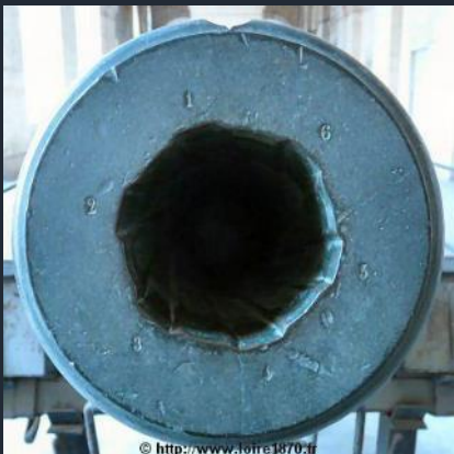
Les six rayures du canon au pas de 2.25 m
